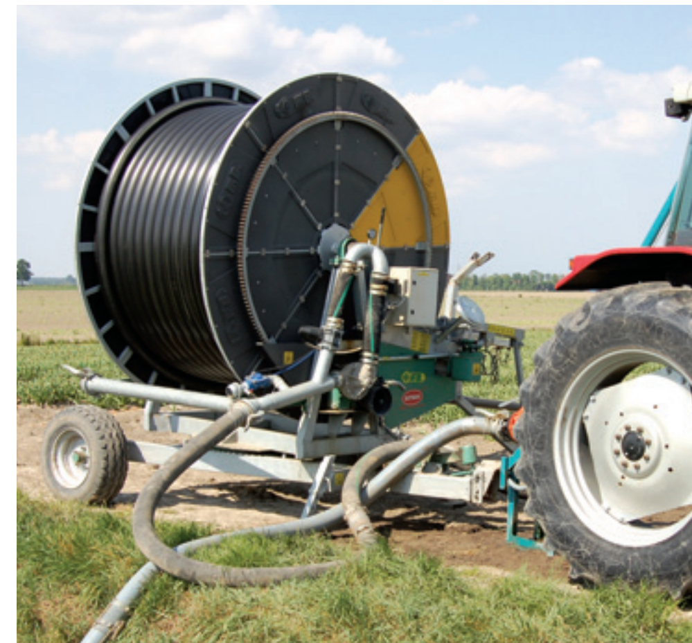
▲ Op deze haspel zit aan de voorkant een turbine met omloopleiding en klep voor regeling intreksnelheid.
