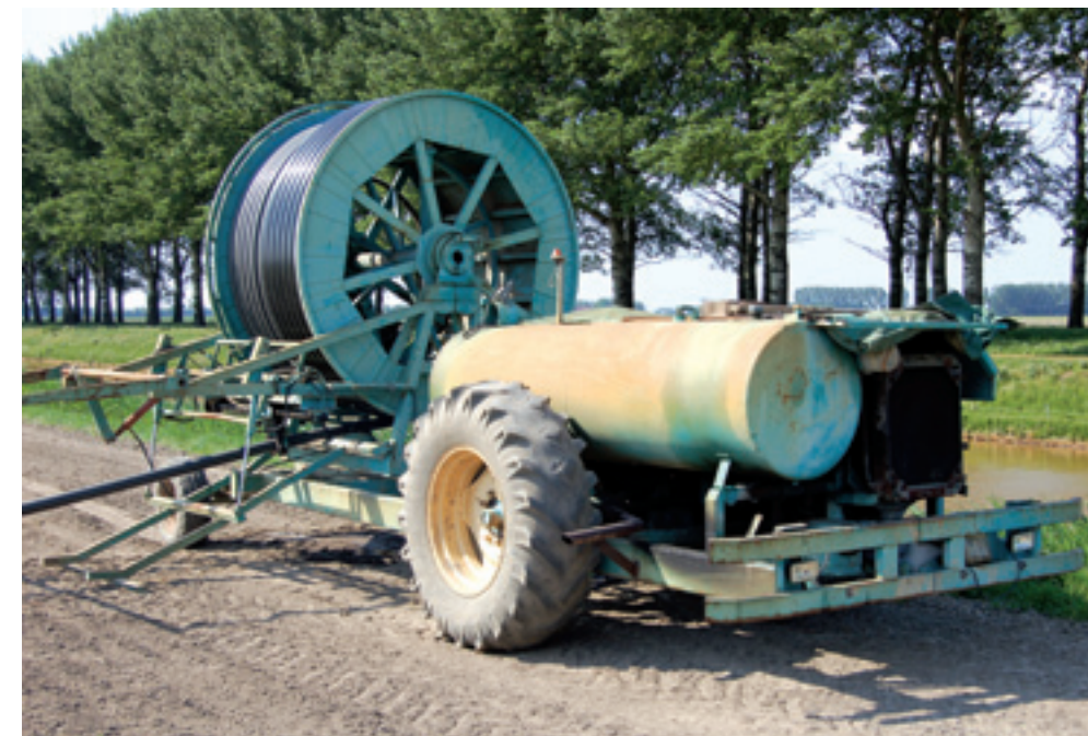
▲ Dwarsgeplaatste haspel en vrachtwagenmotor op een onderstel. Let op voldoende reserve aan vermogen.
