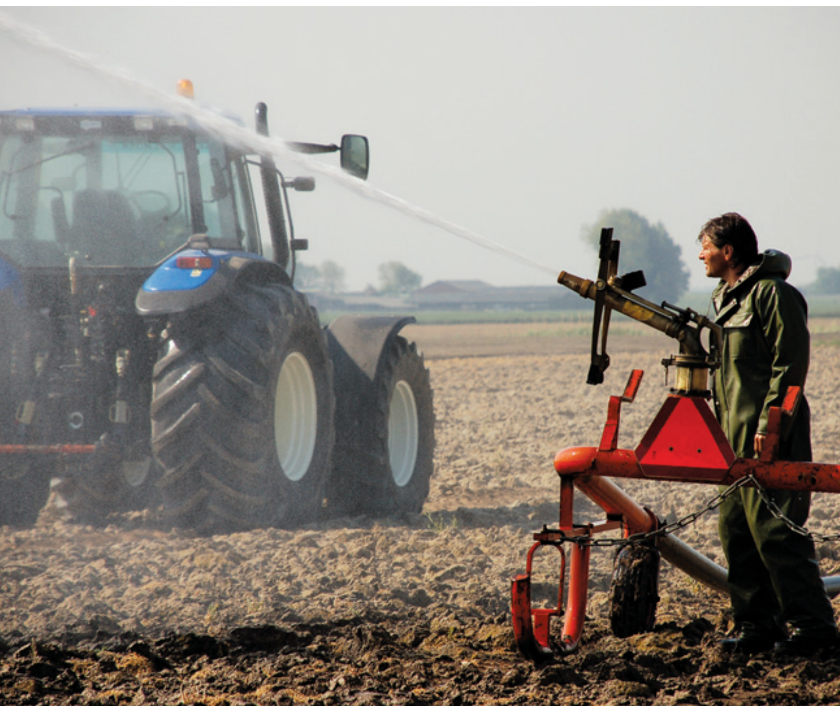
▲ Uittrekken van 500 m slang vraagt een flinke trekker. Toch even de werking en afstelling controleren.
